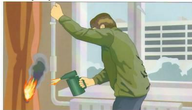
Отогревание замёрзших труб паяльными лампами и факелами
